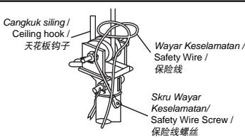
1. Kipas Siling dipasang dalam keadaan selamat pada cangkul siling. / The Ceiling Fan is securely fixed onto the ceiling hook. / 吊扇被稳固地安装到天花板钩子。
