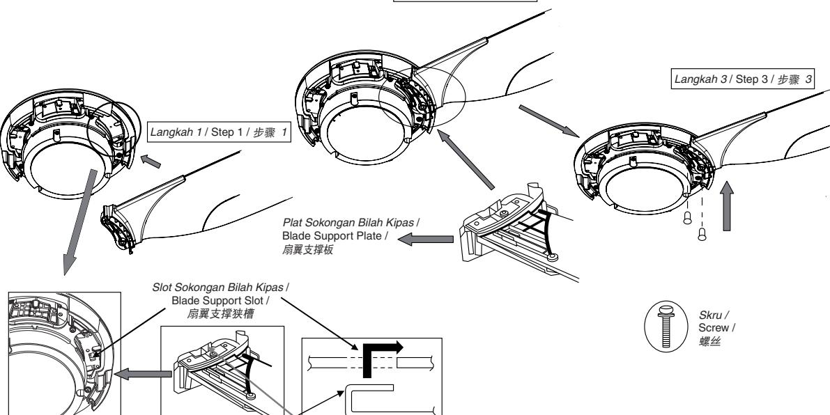
Plat Sokongan Bilah Kipas / Blade Support Plate / 扇翼支撑板
